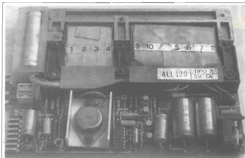
foto 1: Trasformatore F.R. di costruzione Olivetti, a sinistra è ben visibile il condensatore di risonanza C. Si può vedere come il nucleo sia diviso in due parti distinte su cui sono avvolti rispettivamente il primario e gli avvolgimenti secondari.
